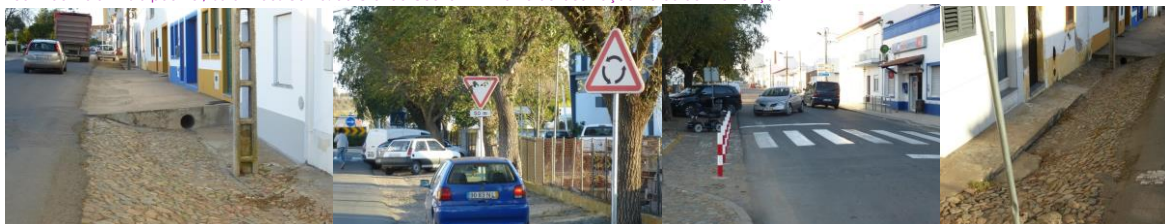
Constrangimentos diversos: Sem passeios; valetas a cota inferior ao arruamento; circulação pedonal na faixa de rodagem; estacionamento colide c/peões e tráfego de veículos
